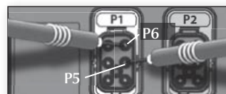
120 VAC au connecteur P1 : P6 et P5
